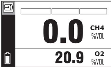
Fig. 24: Modo de medición (aquí: caso de aplicación **Medir**) Izquierda arriba (área de información): Símbolo del caso de aplicación actual
