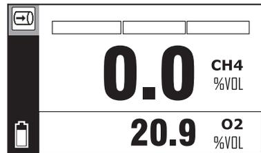
Fig. 4: Pantalla en el modo de medición
